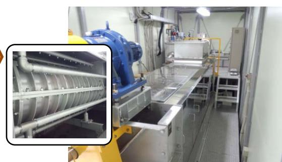
水中から除去されたフロクからなる汚泥をスクリュース式脱水機で脱水します。
