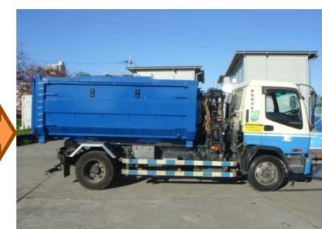
脱水した汚泥をコンテナに貯留し、搬出します。
