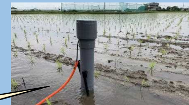
水位水温センサー設置の様子 (H社製品)
