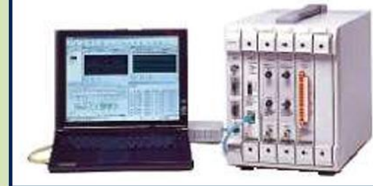
※燃焼振動計測システム 計測イメージ
