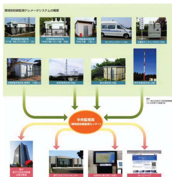
図2 現在の環境放射線監視テレメータシステムの概要
