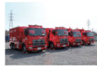
大容量ポンプ車
