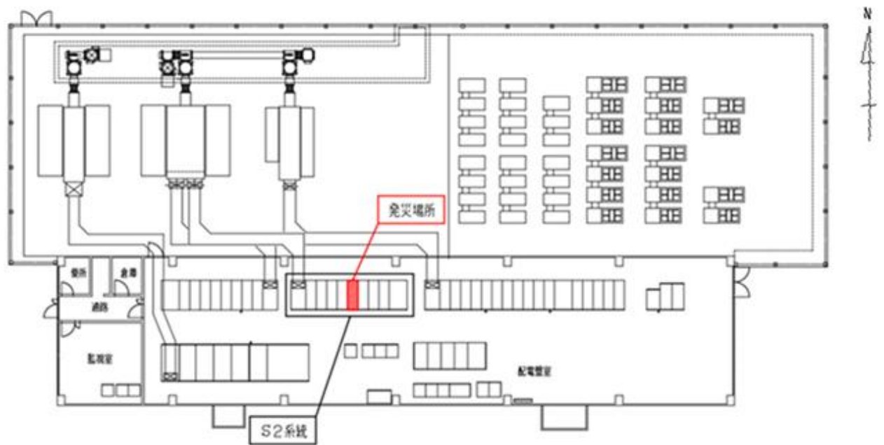
図3 50GeV 変電所内の高圧配電盤の設置
