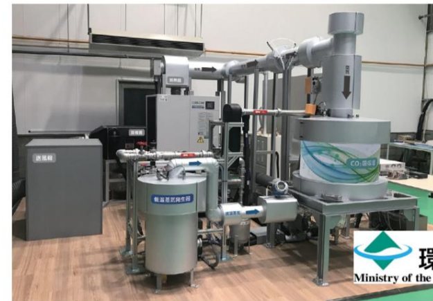
5kg-CO 2 /day Direct Air Capture 実証試験機
