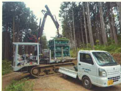
軽トラックからフォワーダへの積み替え状況
