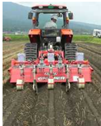
耕うん同時畝立て播種機および成形される畝の形状(左：平高畝・土壤水分59%、右：単条畝・土壤水分38%)
