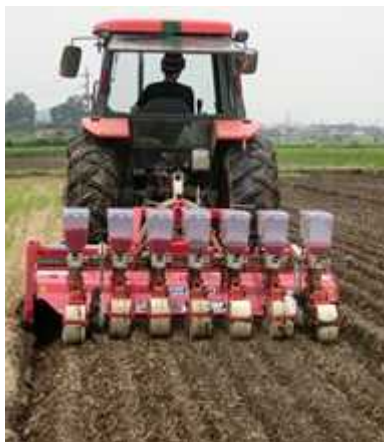
耕うん同時畝立て播種機および成形される畝の形状(左：平高畝・土壤水分59%、右：単条畝・土壤水分38%)
