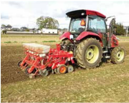
不耕起播種機を使用した乾田直播作業
