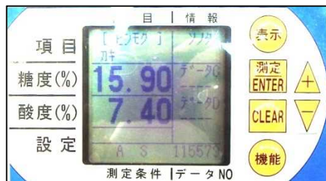
図 3 実機での糖度と脱渋成否評点の出力例
