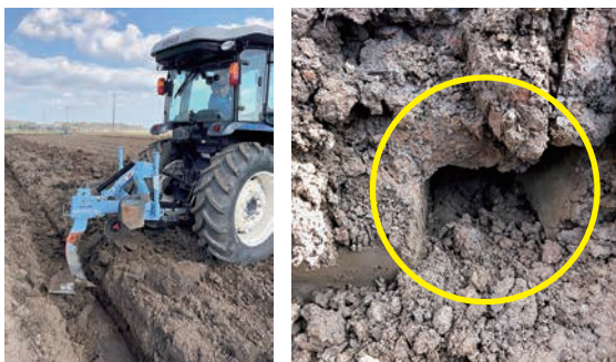
図6-1 明渠およびカットドレーン施工の様子（左）と施工後にできた孔隙（右、丸で囲った部分）
