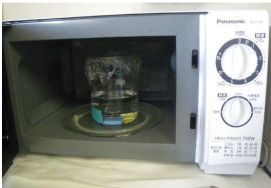
図 2 電子レンジによる迅速固定
