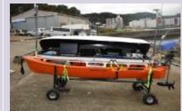
4. 水中用測量ロボット
