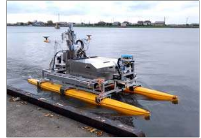
図1.遠隔操作式のフロートロボット NETIS番号(KT-180072-A)
