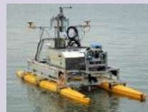
3. 水中用測量ロボット
