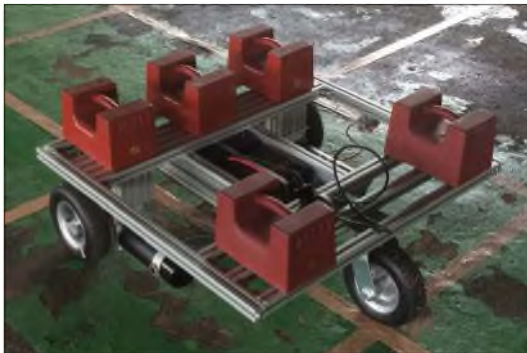
20kg × 5個の重りを載せた走行テスト
