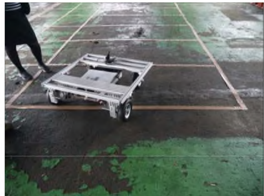
指定された作業ポイントへの自律走行テスト
