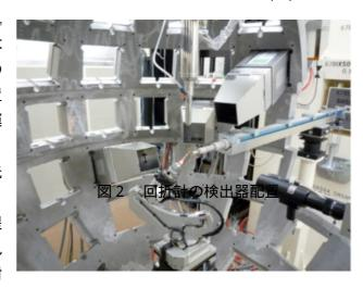
中性子強度の波長依存性と検出器感度の位置および波長依存性の補正を行った。3 台の検出器から得られた TOF 回折パターン上には合計で 100 個近〈の鮮明なブラッグ反射を観測することができた。
