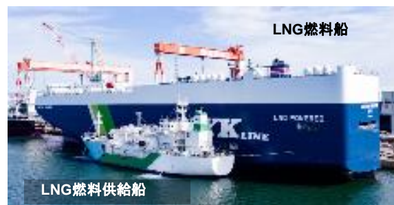
LNGバンカリング
