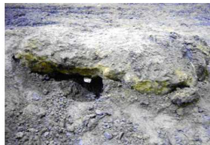
北側で発見されたコンクリート様の塊 (東西1m×南北2m×深さ50cm)
