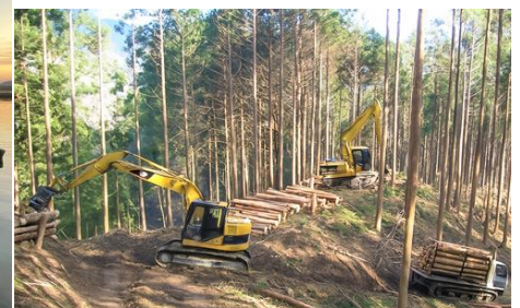
高性能林業機械を活用した人工林の伐採作業
