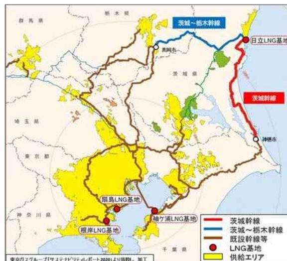
図3-11 茨城幹線（ガスパイプライン）概略図
