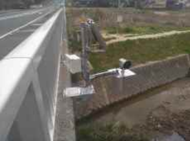
危機管理型水位計の設置イメージ
