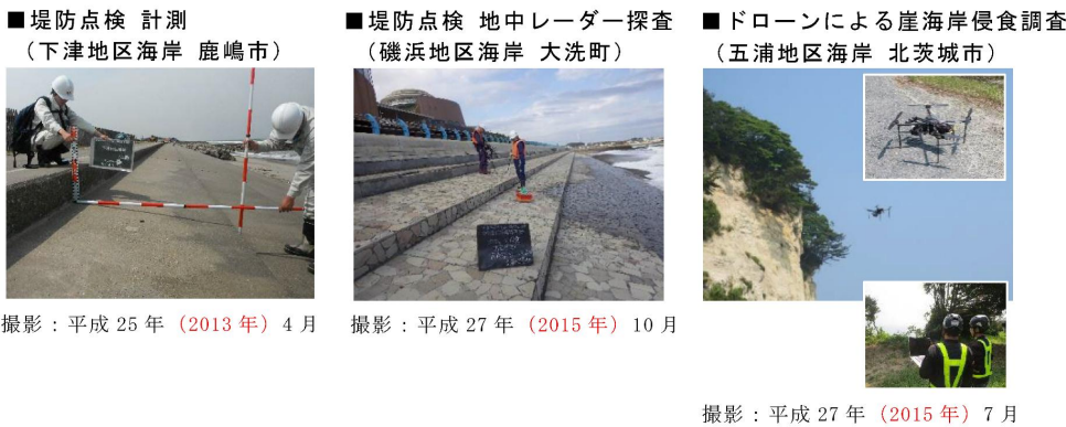
写真 3.8 堤防点検, 崖海岸侵食調査の様子
