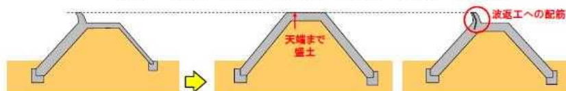
図 3.7 海岸堤防等の「粘り強い構造」の基本的な考え方
