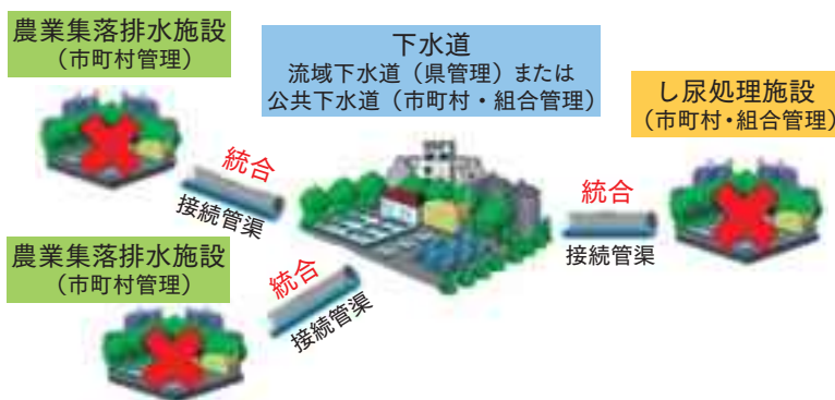
汚水処理施設の統廃合イメージ
