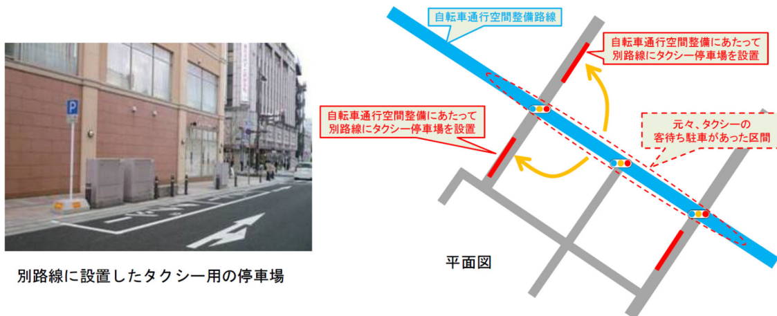
図 9-1 自転車通行空間整備に併せてタクシーの客待ち駐車場を別路線に確保した事例
