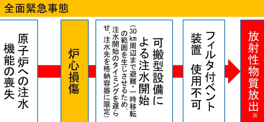
※ 解析上、原子炉への注水機能の喪失から約19時間後と評価
